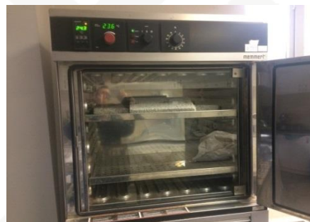
شکل ۷- تثبیت شرایط و قرائت جمع شدگی بلوک های سبک سیمانی
