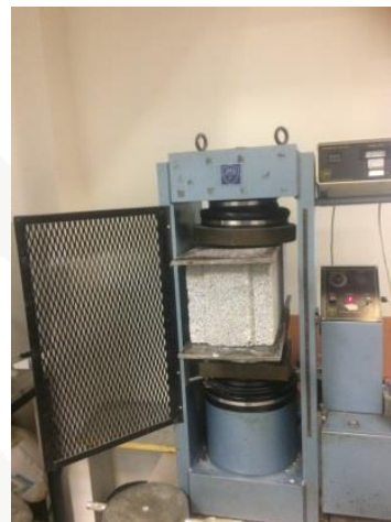
شکل ۵- آزمون تعیین مقاومت فشاری بلوک های سبک
