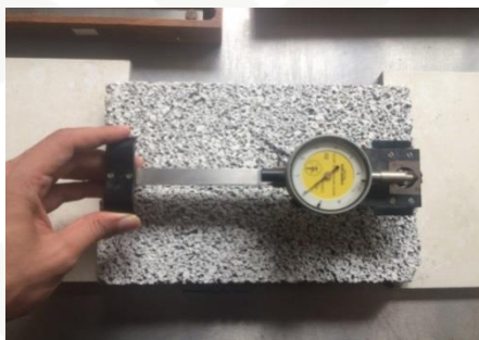
شکل ۷- تثبیت شرایط و قرائت جمع شدگی بلوک های سبک سیمانی
